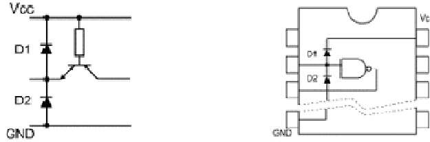
Şekil 2. IC pinlerindeki koruma diyot yapıları.
